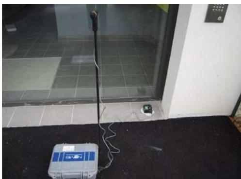
Des capteurs de vibrations installés au sein des habitations pour mesurer les éventuels effets des tirs de mines consécutifs au percement du tunnel de Talant
