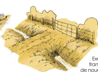
Aménagement de noue visant à temporiser et à infiltrer les eaux de ruissellement
