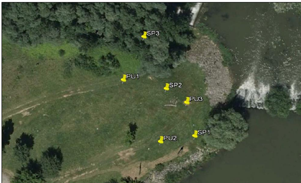
Fig. 4. Localisation des différentes investigations géotechniques
