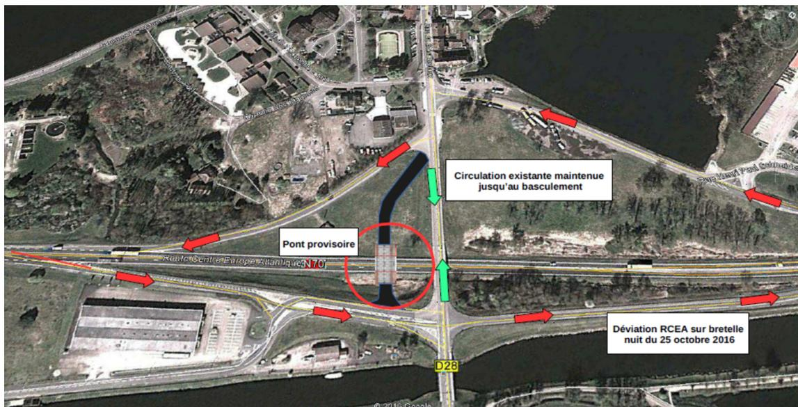
Cet ouvrage à structure métallique de 28,00 m de long pour une largeur de 12,80 m permettra le trafic sur 2 voies de circulation. Une passerelle piétons est également prévue.
