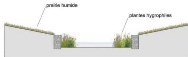
Bassin de rétention type 2 (avec gabions) : plantation sur une emprise de 2 x 2 mètres + prairie humide sur talus
