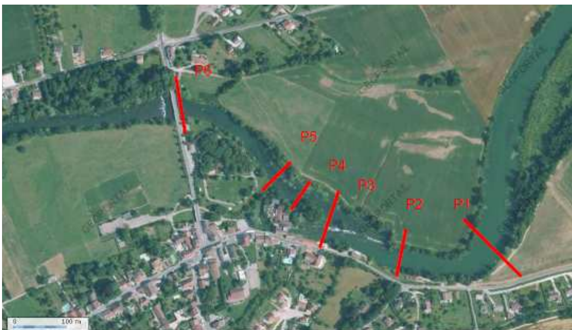
Figure 5 : Profils en travers relevés en 2008
