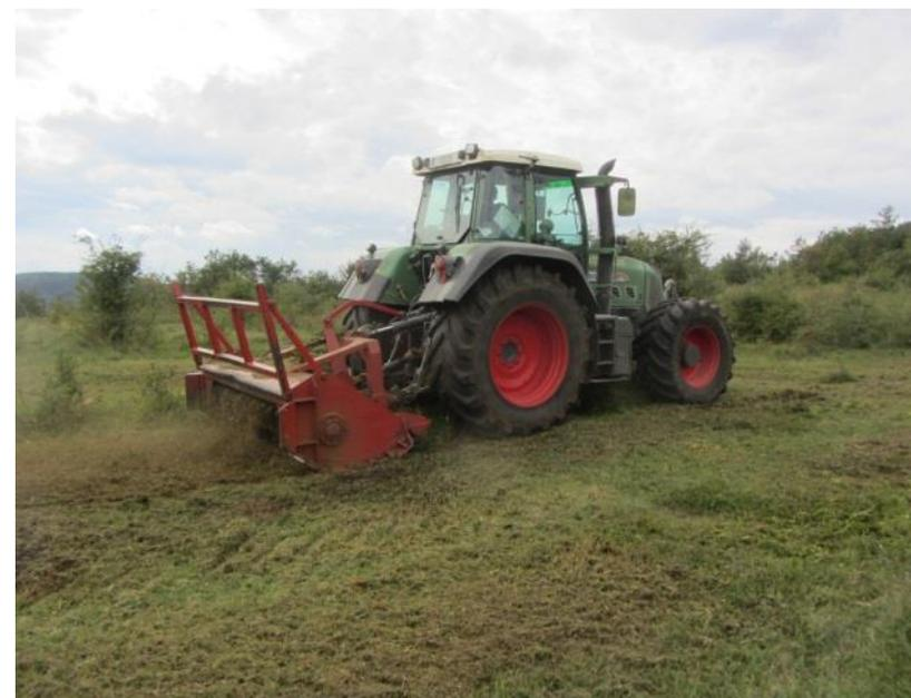
Figure 26 : Broyage de rejets et broussailles
