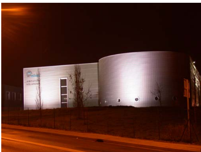
Les projecteurs encastrés au sol éclairent ces façades sans créer de nuisances visuelles. Toutefois les projecteurs mal réglés envoient inutilement de la lumière vers le ciel (gaspillage d'énergie, pollution lumineuse du ciel).
