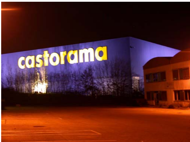
Les projecteurs encastrés au sol assurent une bonne mise en valeur de ces façades. Dans ce cas, les projecteurs ne sont pas suffisamment bien cadrés, et une partie du flux lumineux se perd dans le ciel.
