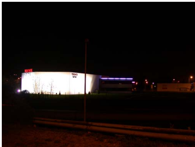
La façade est très lumineuse. Les projecteurs posés au sol peuvent créer des nuisances visuelles et de plus ils projettent largement leur flux lumineux dans le ciel.
