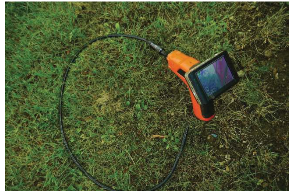
Figure 8 - Endoscope utilisé pour l'examen des gîtes
