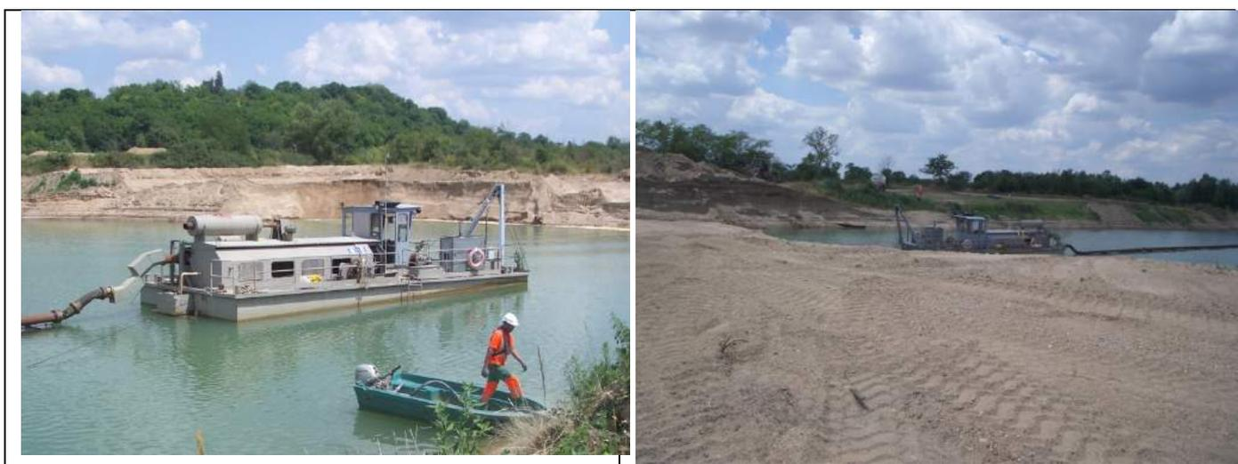
Illustration 27 : drague flottante et alluvion sableuse
