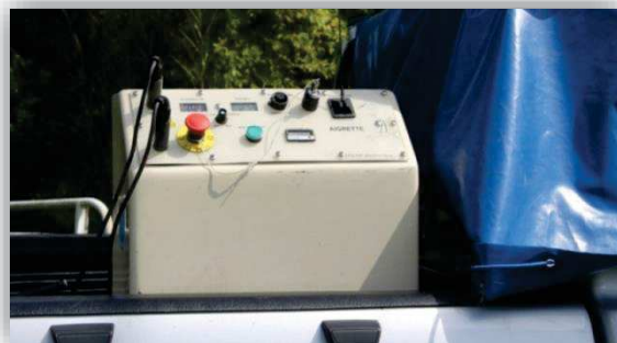
Figure 23 : Photographie du matériel de type DREAM électronique, modèle aigrette (source Fédération de Pêche de la Nièvre)
