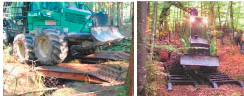
Figure 99 : Rampes métalliques pour le franchissement du fossé (Source : CC Gorges de la Haute Dordogne)
