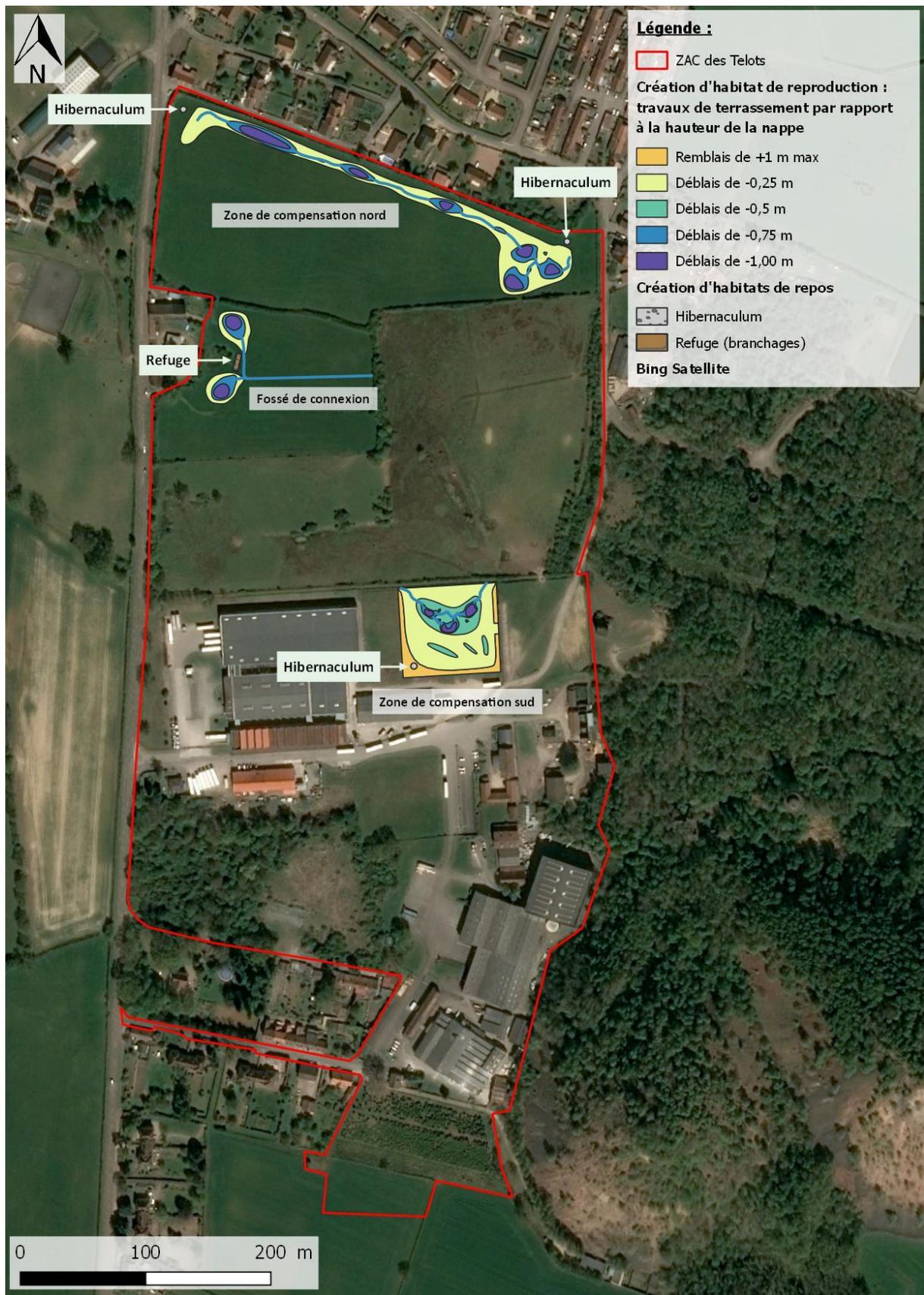
Plan des aménagements de la mesure MC1 dans les zones de compensation
