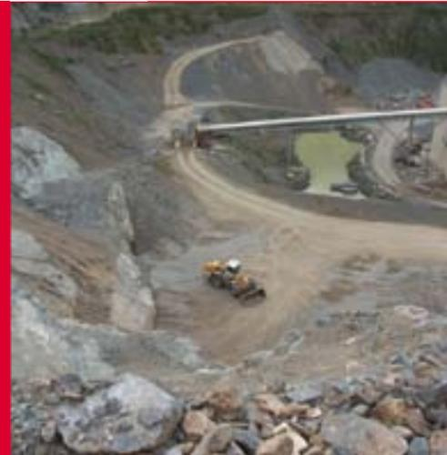
Inspection de la carrière de Lepuix Gy (90) exploitant à flanc de montagne le porphyre, roche éruptive siliceuse très dure, utilisée dans les enrobés de chaussée et comme ballast sur les voies ferrées.
