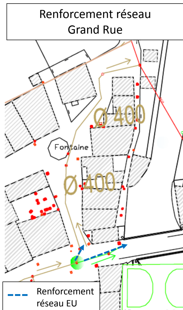
Figure 5 : Travaux de renforcement du réseau de Grand Rue
