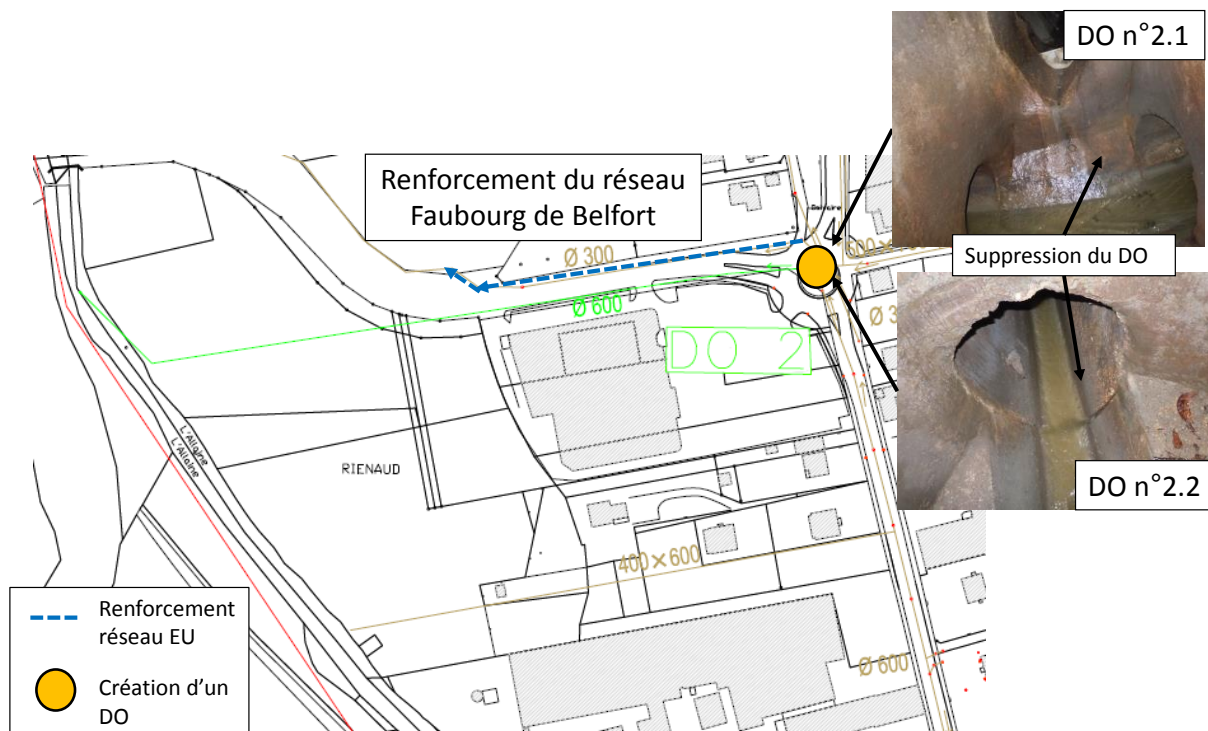
Figure 2 : Travaux de création de bassin d'orage et de renforcement de réseau Faubourg de Belfort
