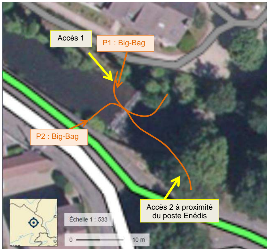
Fig. 37. Points de mise à sec de la zone de chantier à l'ouvrage ROE55861
