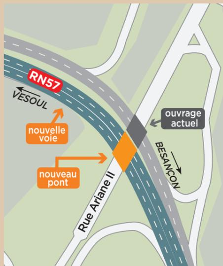
La solution retenue est de ne pas élargir le pont actuel mais d'en construire un nouveau à côté, afin de permettre le franchissement de la rue Ariane II par la « nouvelle » RN57 à 4 voies, sans perturber les conditions de circulation pendant les travaux.
