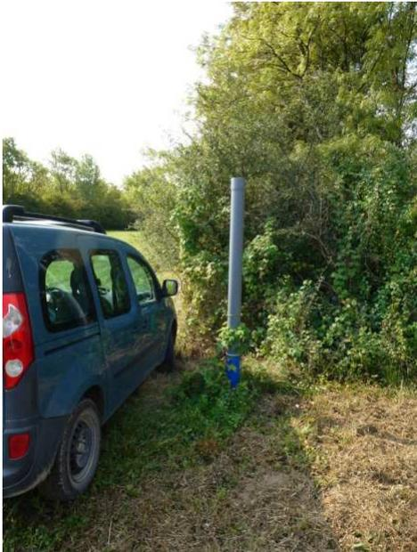
Vue sur piézomètre (tube PVC rajouté pour éviter immersion du capteur)
