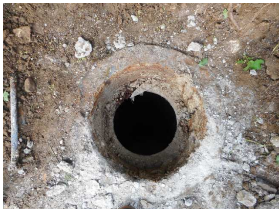
Figure K- 13 : Tête du sondage n°6 dégagée
