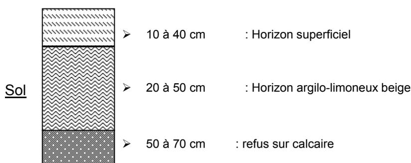
Suivant les sondages, l'épaisseur de l'horizon superficiel varie entre 10 et 40 cm. Celle de l'horizon sous-jacent varie entre 20 et 50 cm.
