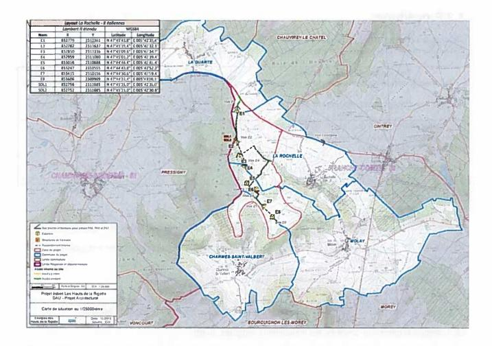
Le projet envisagé est constitué de 8 éoliennes (E1 à E8) de différents modèles et fabricants, dont le gabarittype serait de 180 m en bout de pâle, avec une hauteur au moyeu de 110 à 125 m, un rotor de 130 m de diamètre, et 45 m entre le sol et le bout des pâles.
