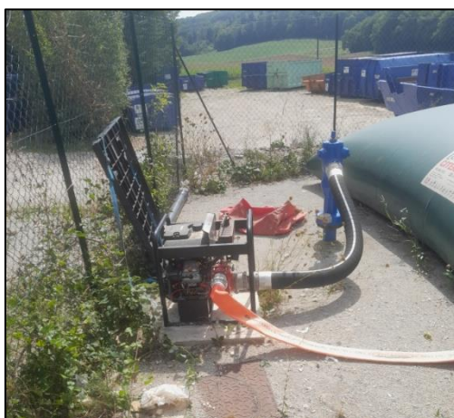
Figure 11 : Branchement des 2 lances à la motopompe
