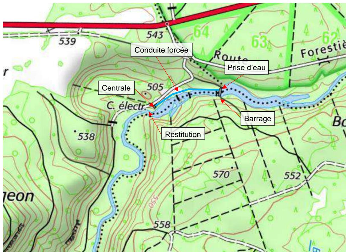
Figure 2 : Localisation des installations de la centrale (Source : Géoportail)
