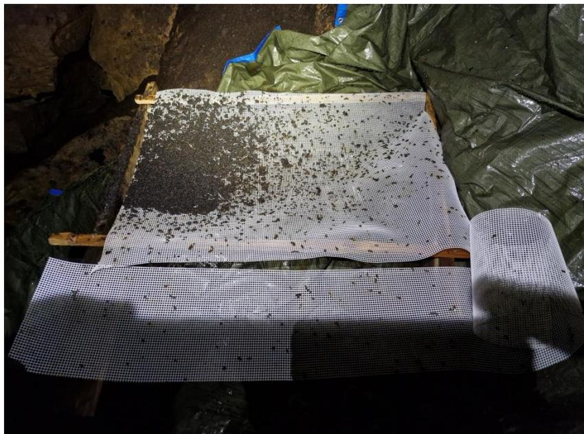
Le guano a été prélevé à l'aide de tube à essai et de cures dents changés pour chaque prélèvement afin d'éviter toute contamination entre les échantillons.
