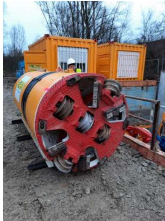
Micro tunnelier sous autoroute A35
