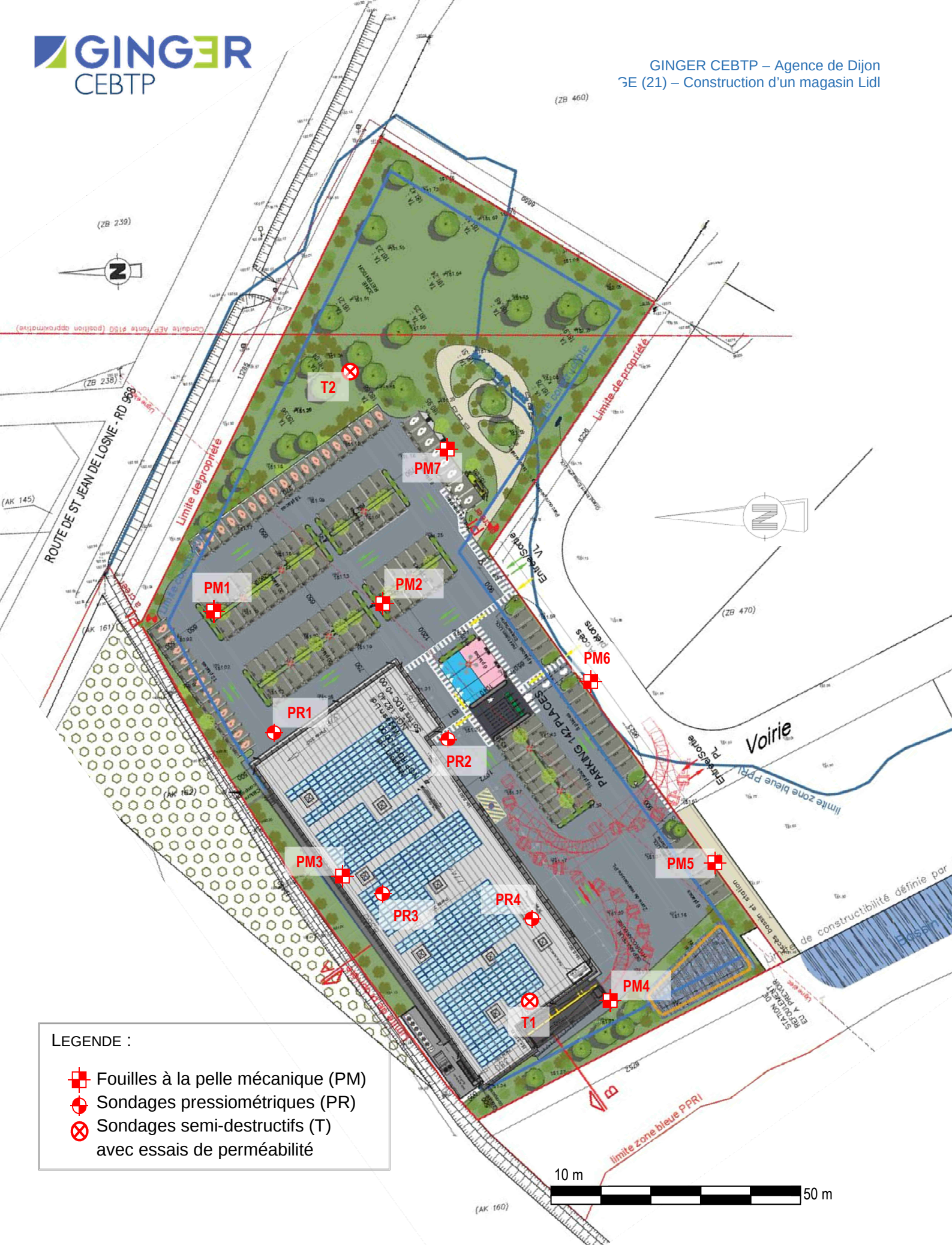
Figure 11 : Plan d'implantation des sondages géotechniques
