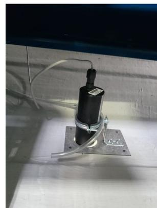
Microphone smart installé en nacelle
