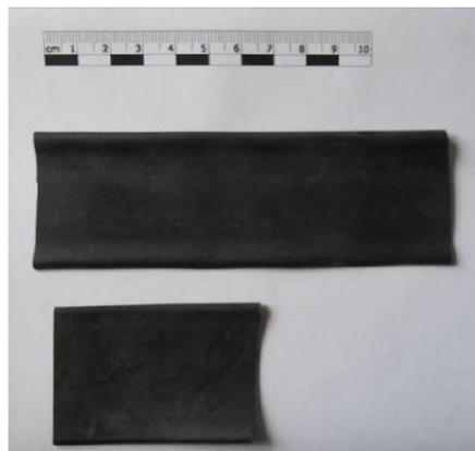
Type de leurres utilisés dans le cadre des tests d'efficacité de recherche : morceaux de chambre à air noire
