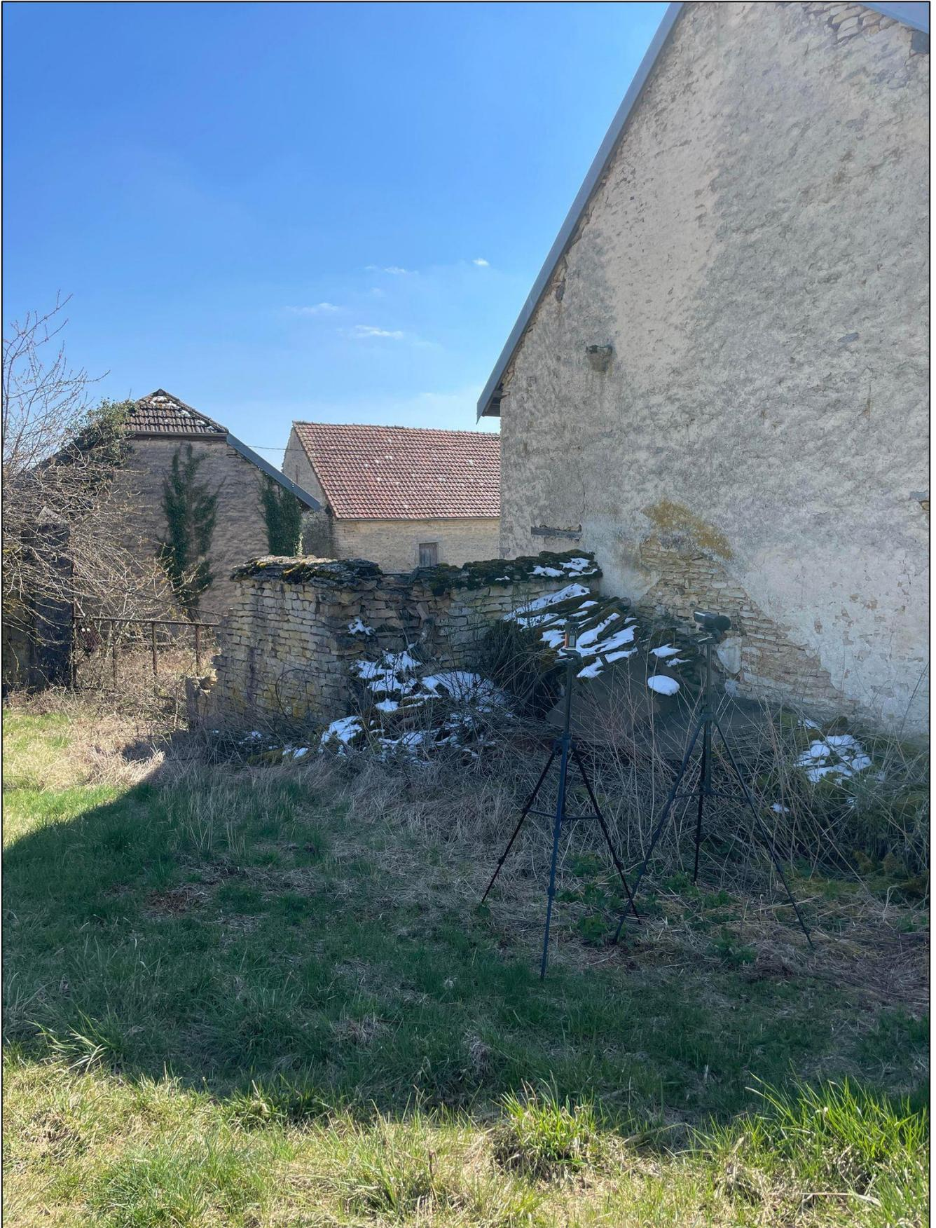
Figure 12 : Photographie du sonomètre lors des mesures des niveaux sonores en limite de Zone à Emergence Réglementée (Point ZER-2 sur Figure 1)
