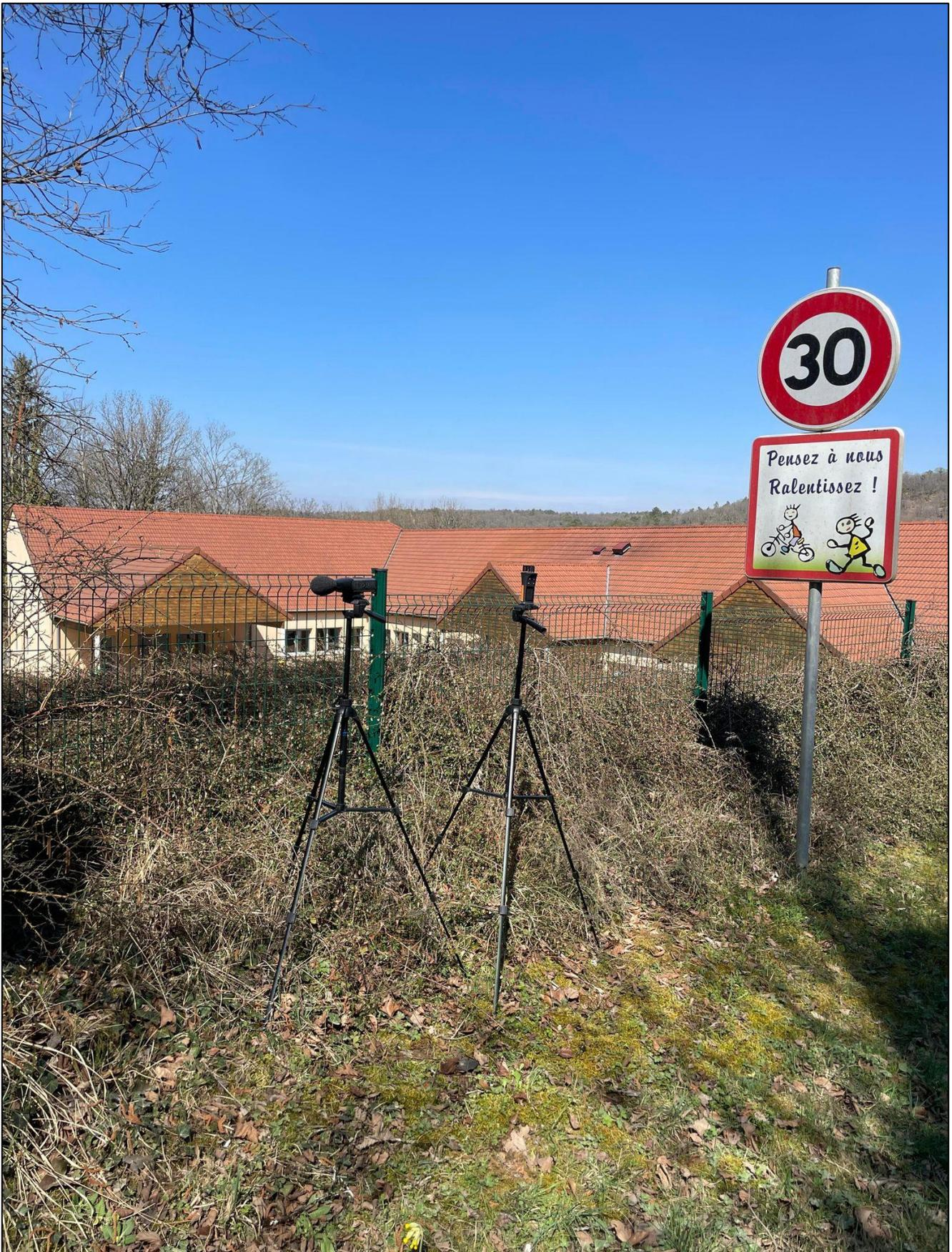
Figure 11 : Photographie du sonomètre lors des mesures des niveaux sonores en limite de Zone à Emergence Règlementée (Point ZER-1 sur Figure 1)
