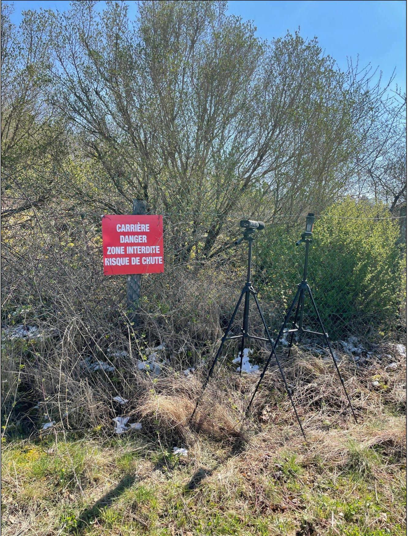
Figure 10 : Photographie du sonomètre lors de la mesure du niveau sonore en limite de site (point LIM sur la Figure 1)
