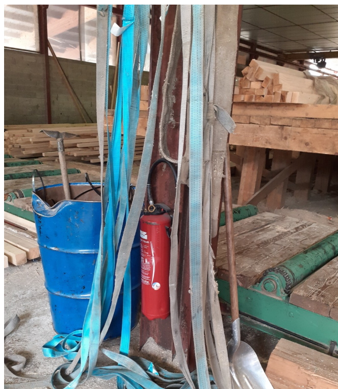
Extincteur non visible
