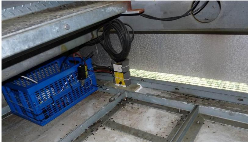
Figure 9 - Installation de l'Anabat et batteries à l'arrière gauche de la nacelle d'E10
