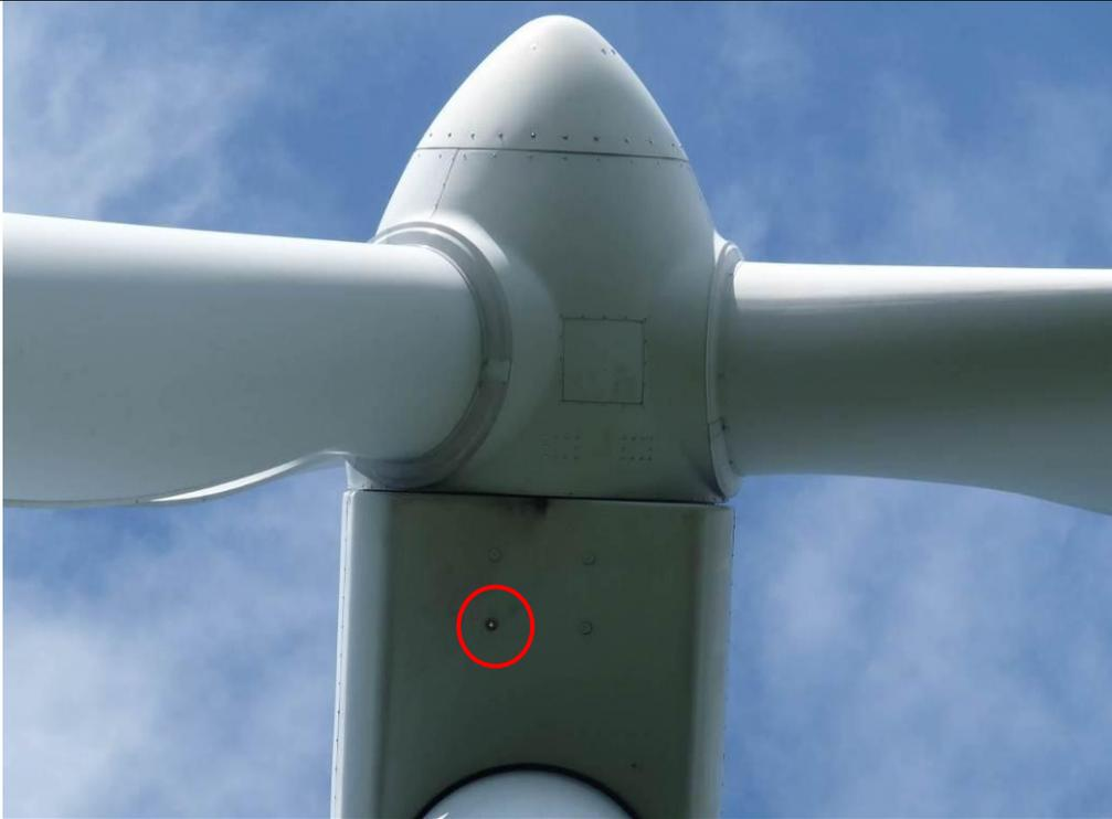
Figure 11 : Position du micro de l'Anabat SD2 dans l'éolienne E4 (entre les pales et le mât)
