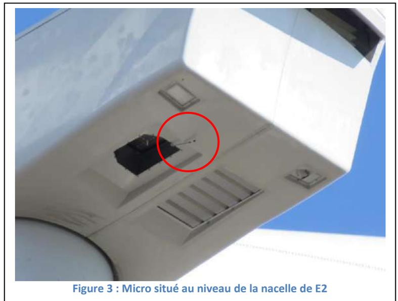
Cet enregistreur comporte 2 micros à ultrasons : l'un au sol au pied l'éolienne, le second à 100 m du niveau du sol, déporté à l'arrière de la nacelle. Outre la détermination de l'activité chiroptérologique au niveau de la nacelle, une comparaison de l'activité peut donc aussi être effectuée entre les deux micros.
