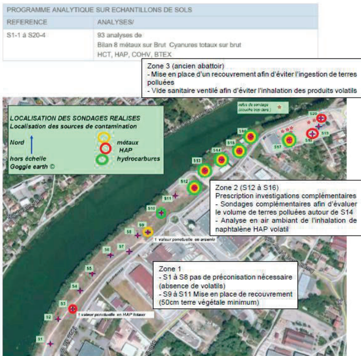
139. Localisation des zones de sources de contamination détectées. Bureau Veritas Janvier 2014
