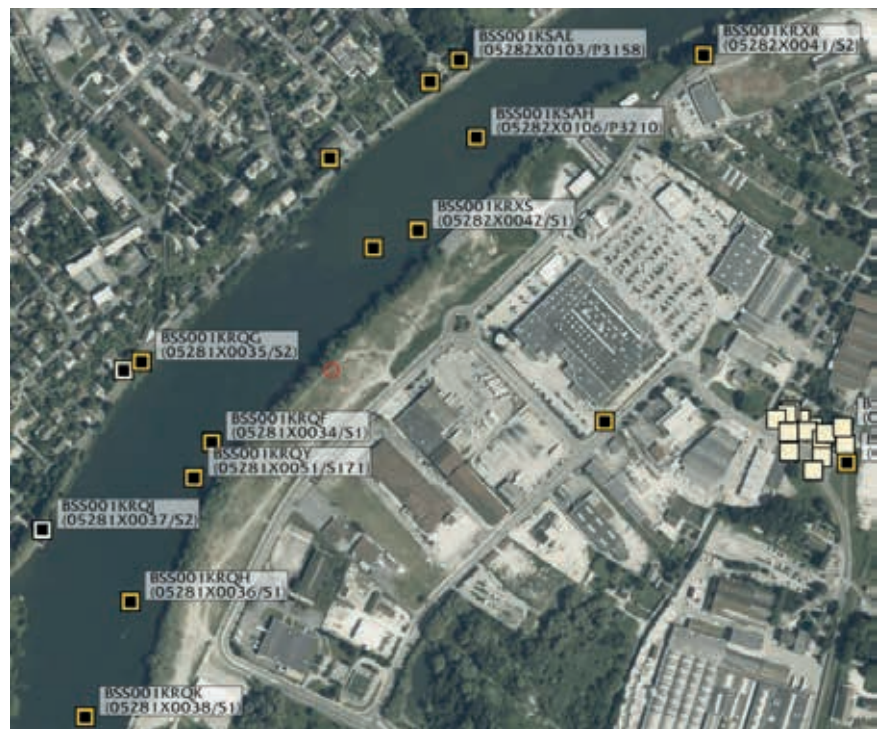
128. Relevés stratigraphiques et plan de localisation des sondages
