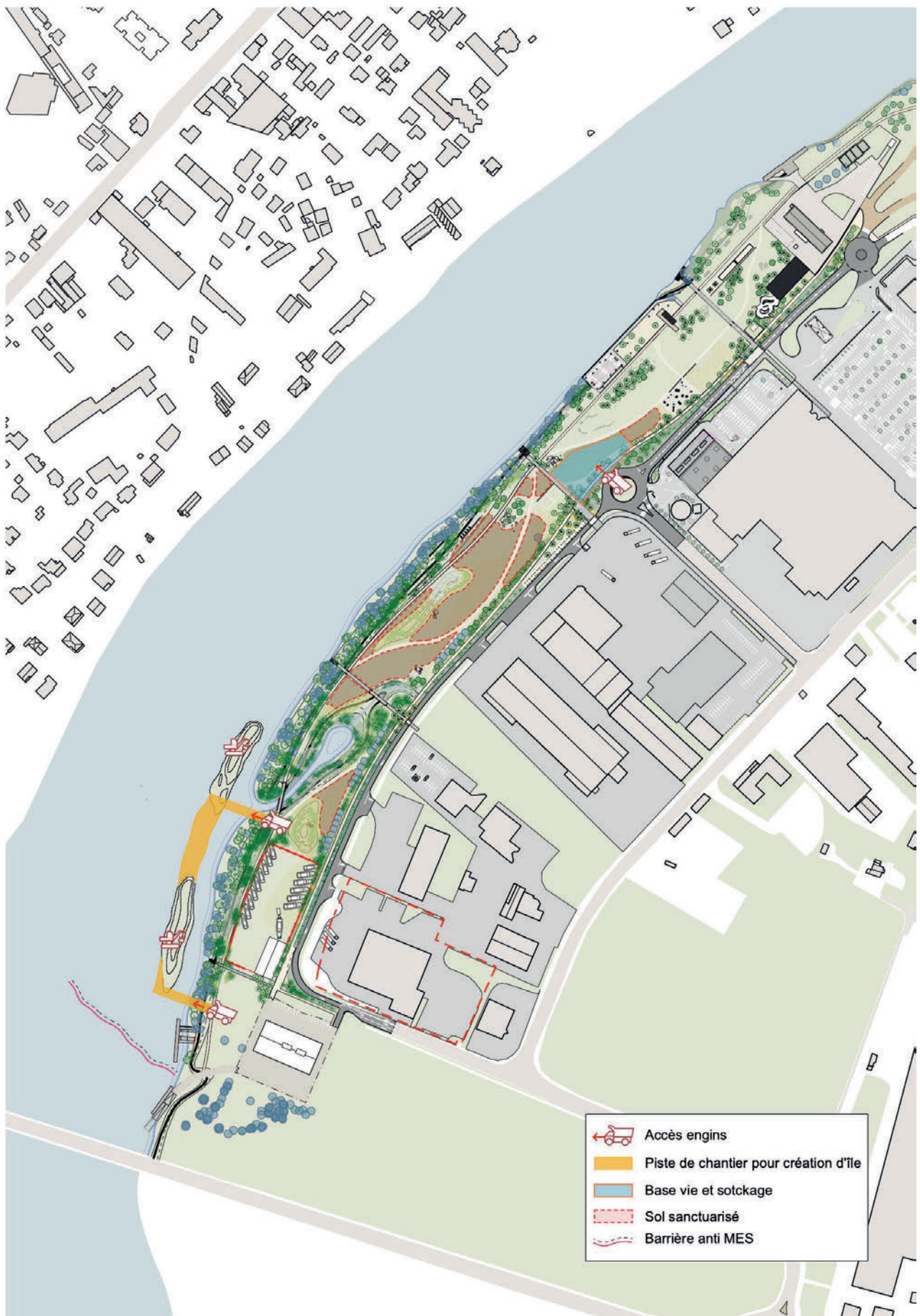
196. Plan installation de chantier
