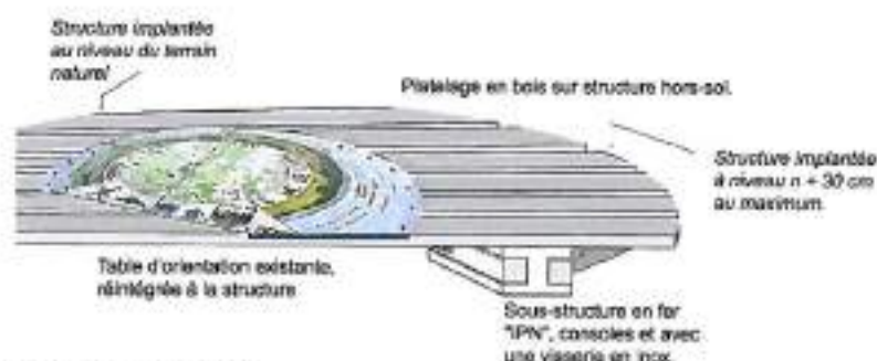
Croquis technique : Principe d'implantation de la structure de platelage en bois "affleurant"
