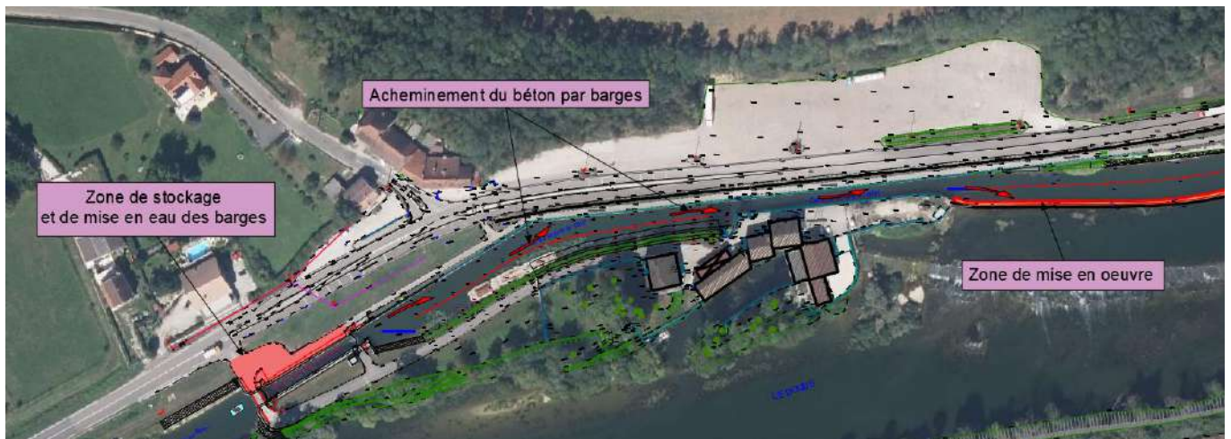
Figure 37. Acheminement du béton par la voie d'eau
