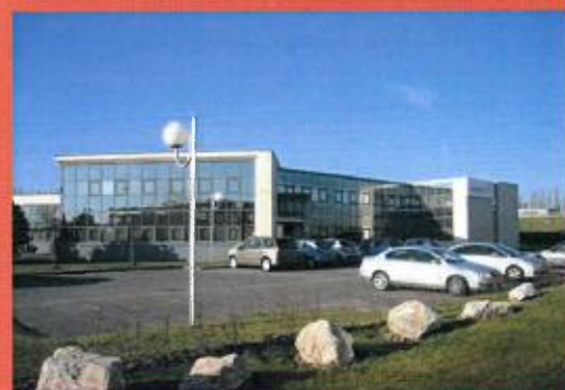
L'éclairage avec des boules opales réduit de 30% l'efficacité des luminaires et crée des nuisances lumineuses.
