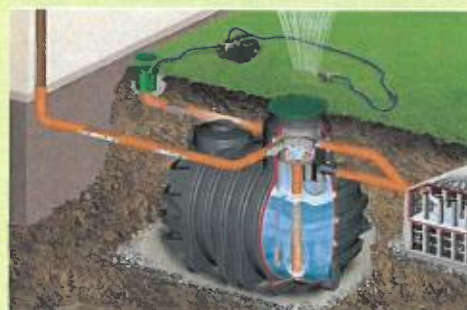
Cuve de rétention des eaux pluviales. Ces cuves enterrées au droit des évacuations permettent une réutilisation des eaux pluviales.
