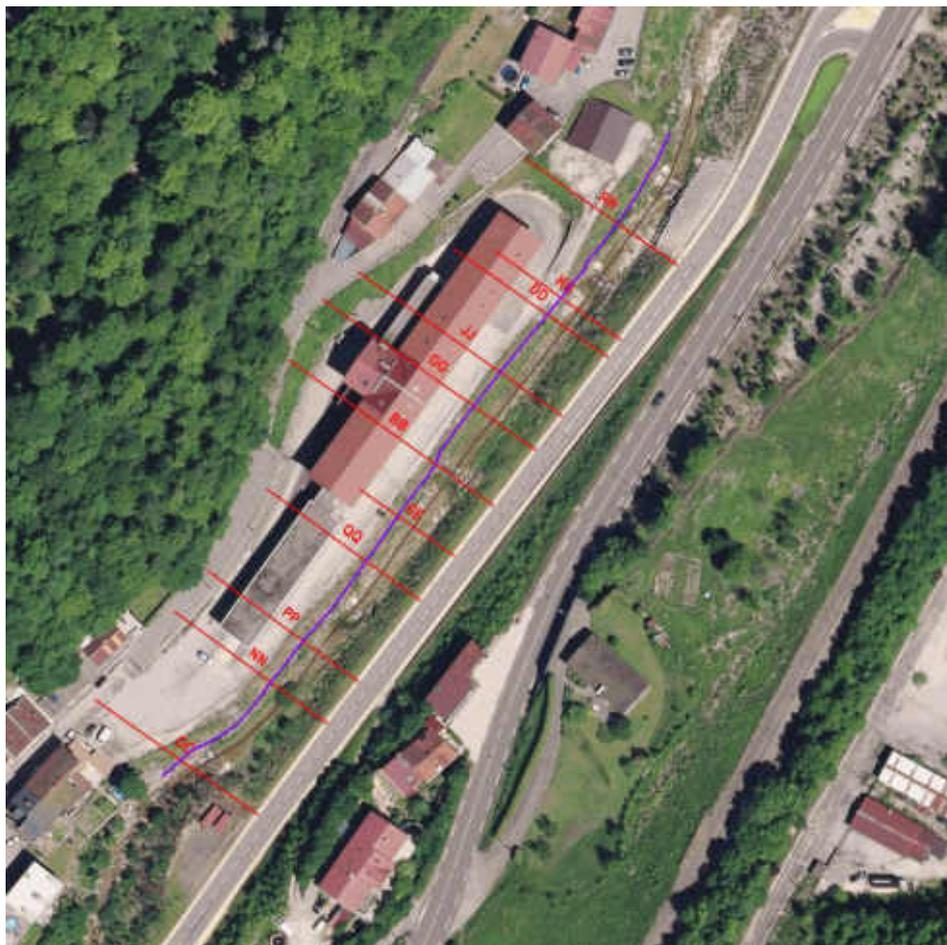
Figure 23 - vue en plan, coupes du dossier architecte, ligne d'énergie et fond (même code couleur que la figure précédente) - échelle 1/2000<sup>ème</sup>
