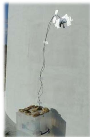
Photo 16 : SM2Bat+ installé au pied d'une éolienne
