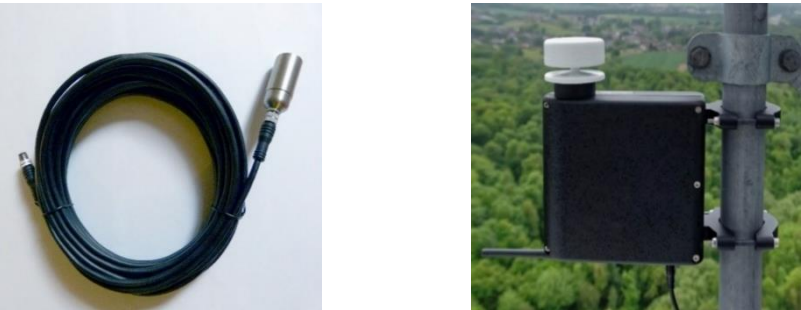
Figure 3 : Microphone mobilisé pour les études en altitude (à gauche) et boîtier TrackBat avec microphones intégrés, installé sur la nacelle d'une éolienne (à droite).
