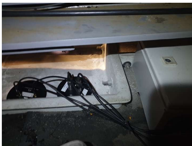
Figure 2 : Exemple de BatMode installé dans une nacelle d'éolienne
