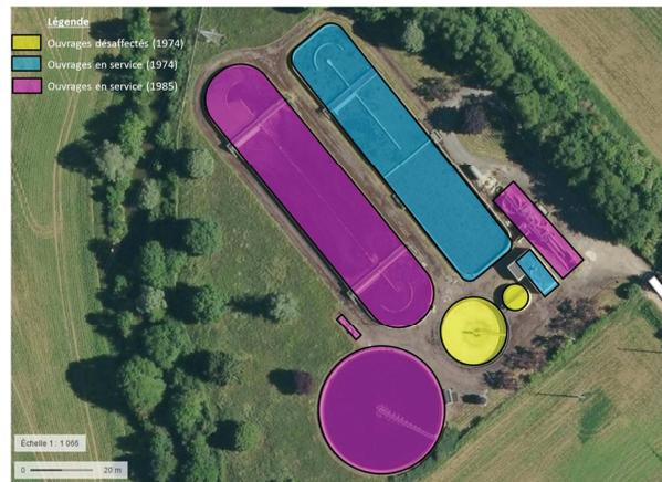
**Fig. 4. Ouvrages de la STEP selon leurs phases de construction et leur usage**
