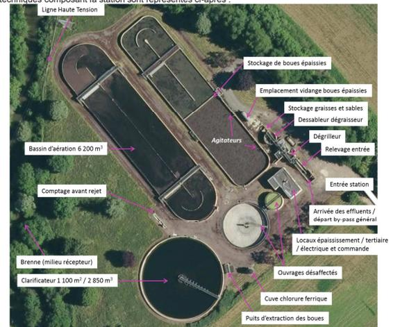
**Fig. 5. Légende des ouvrages de la STEP**
