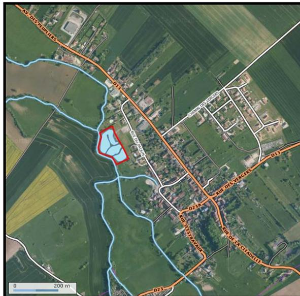
**Avec environ 440 habitants raccordés en 2011 à la station d'épuration, cette dernière dispose encore d'une légère marge avant d'atteindre sa capacité nominale (600EH). Toutefois, il est fort probable que la capacité hydraulique de la station arrive à saturation du fait des eaux claires parasites.**
