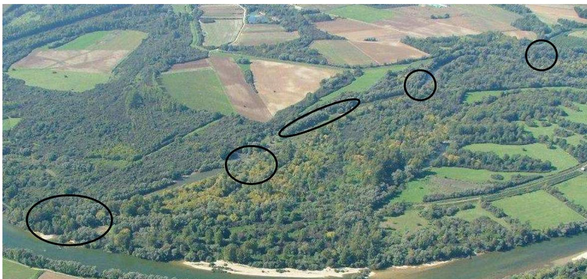
**Figure 10 Vue aérienne 2007 et focus sur les bouchons alluviaux du Vieux Doubs (cercles noirs)**
