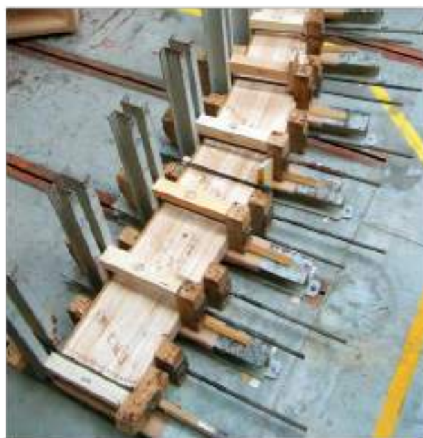
Fabrication des arcs lamellés-collés
