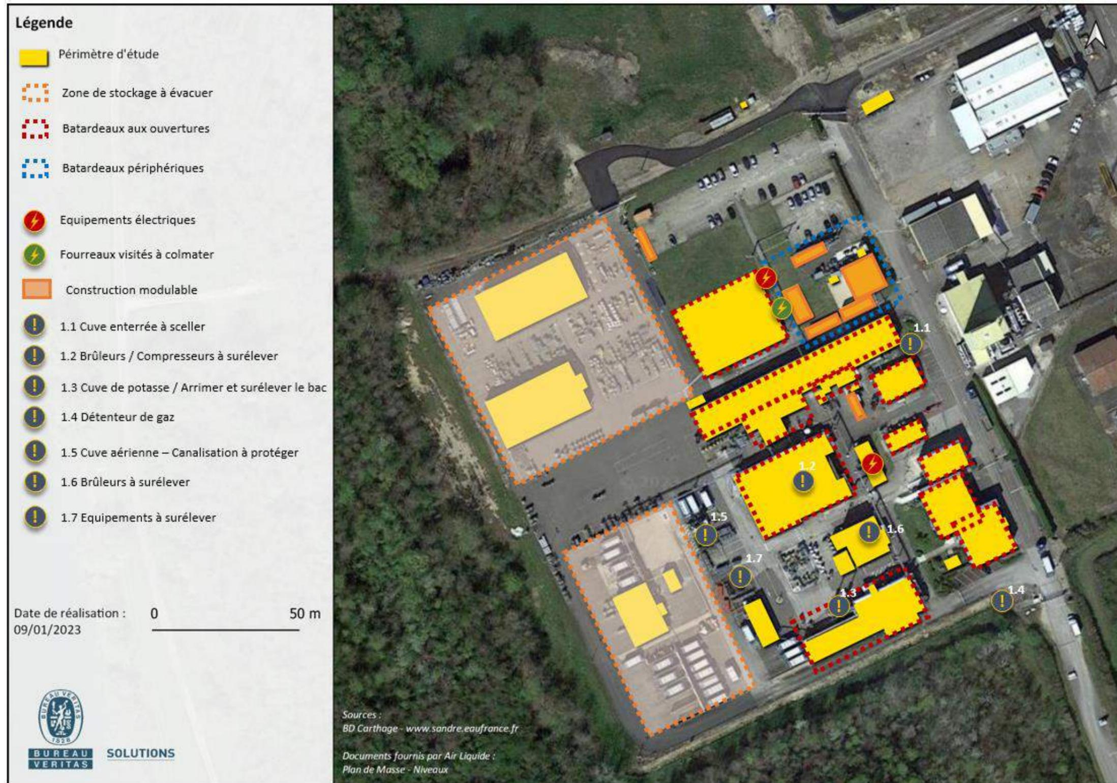
Figure 7: Localisation des principales mesures à mettre en place à l'échelle du site
