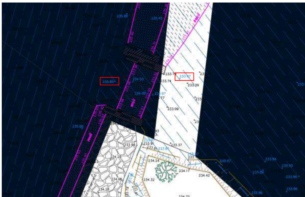
Figure 9 : Extrait du relevé topographique de la zone du barrage (vanne de dégrèvement)
