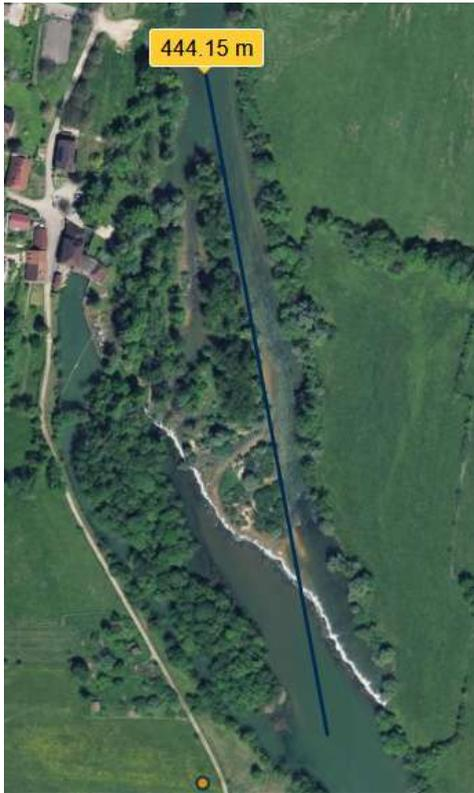
Entre l'entrée du canal d'amenée et la restitution du canal de rive gauche (le plus en aval), le tronçon de court d'eau court circuité fait actuellement 445 m linéaire (cf. ci-contre).
