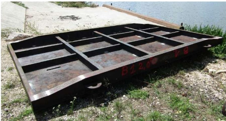
**Figure 62 : Photo d'un batardeau type VNF**
