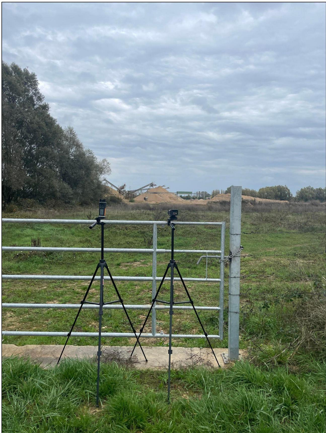
Figure 15 : Photographie du sonomètre lors de la mesure du niveau sonore en limite de site (point LIM-1 sur la Figure 1)
