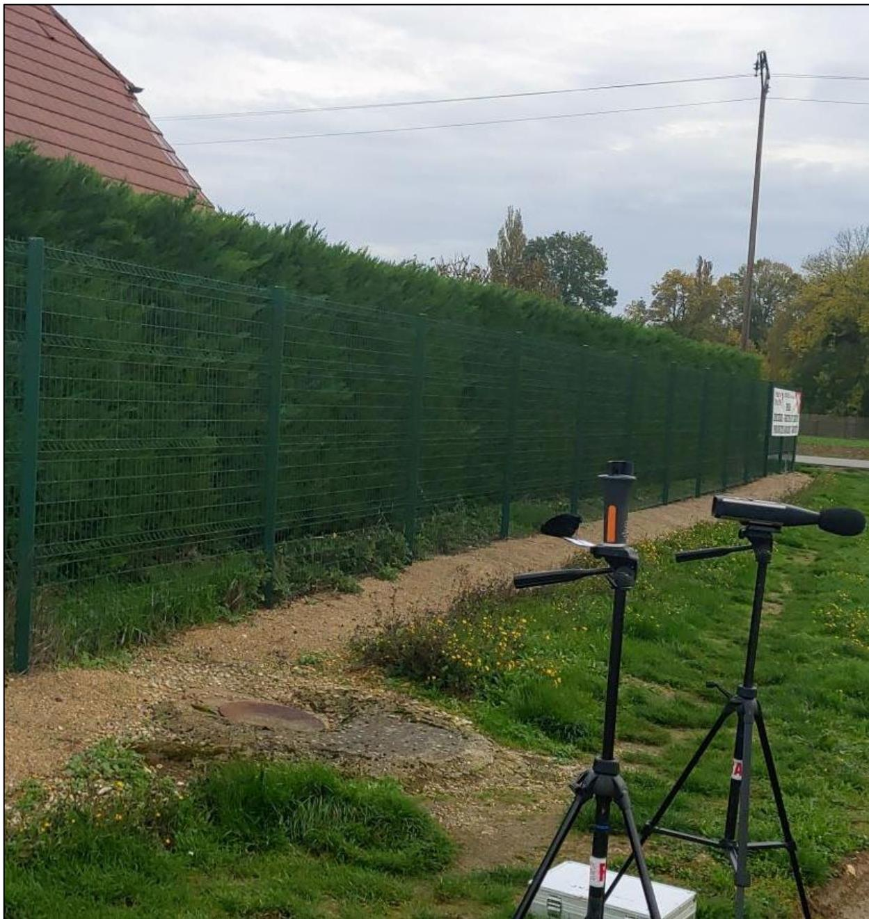
Figure 18 : Photographie du sonomètre lors des mesures des niveaux sonores en limite de Zone à Emergence Règlementée (Point ZER-2 sur Figure 1)
