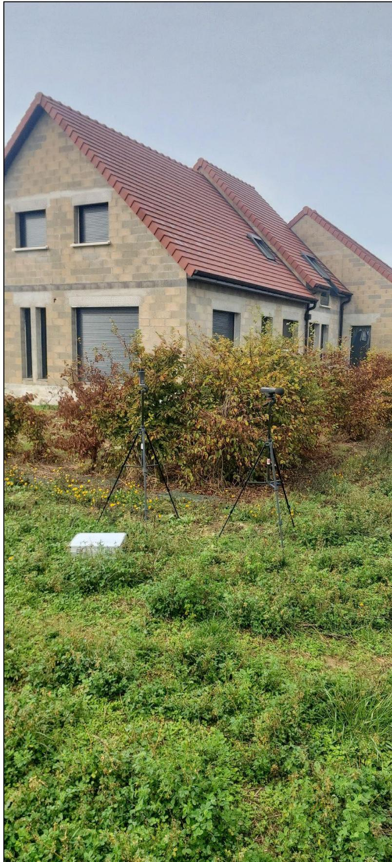
**Figure 17 : Photographie du sonomètre lors des mesures des niveaux sonores en limite de Zone à Emergence Réglementée (Point ZER-1 sur Figure 1)**
