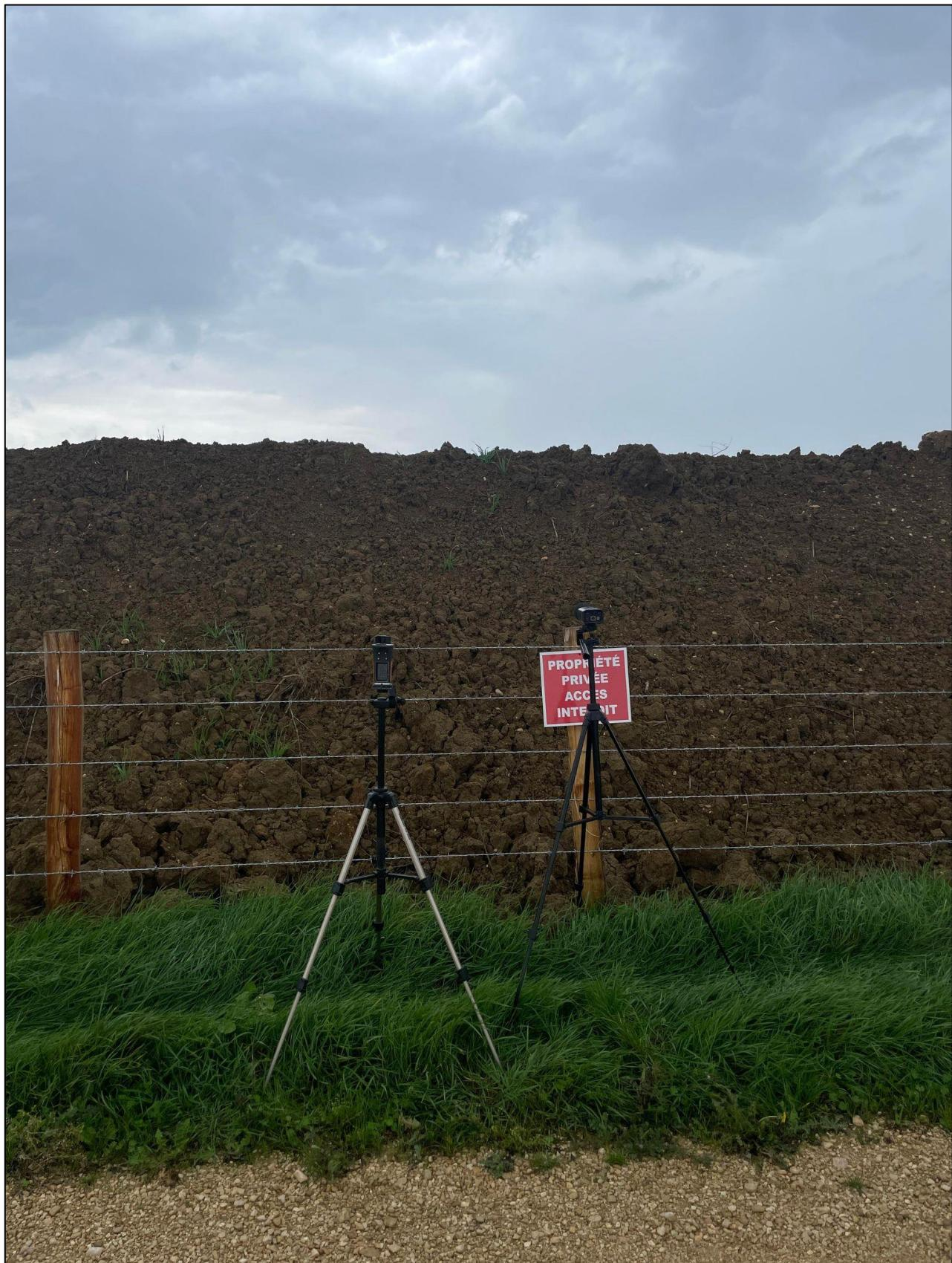
Figure 16 : Photographie du sonomètre lors de la mesure du niveau sonore en limite de site (point LIM-2 sur la Figure 1)
