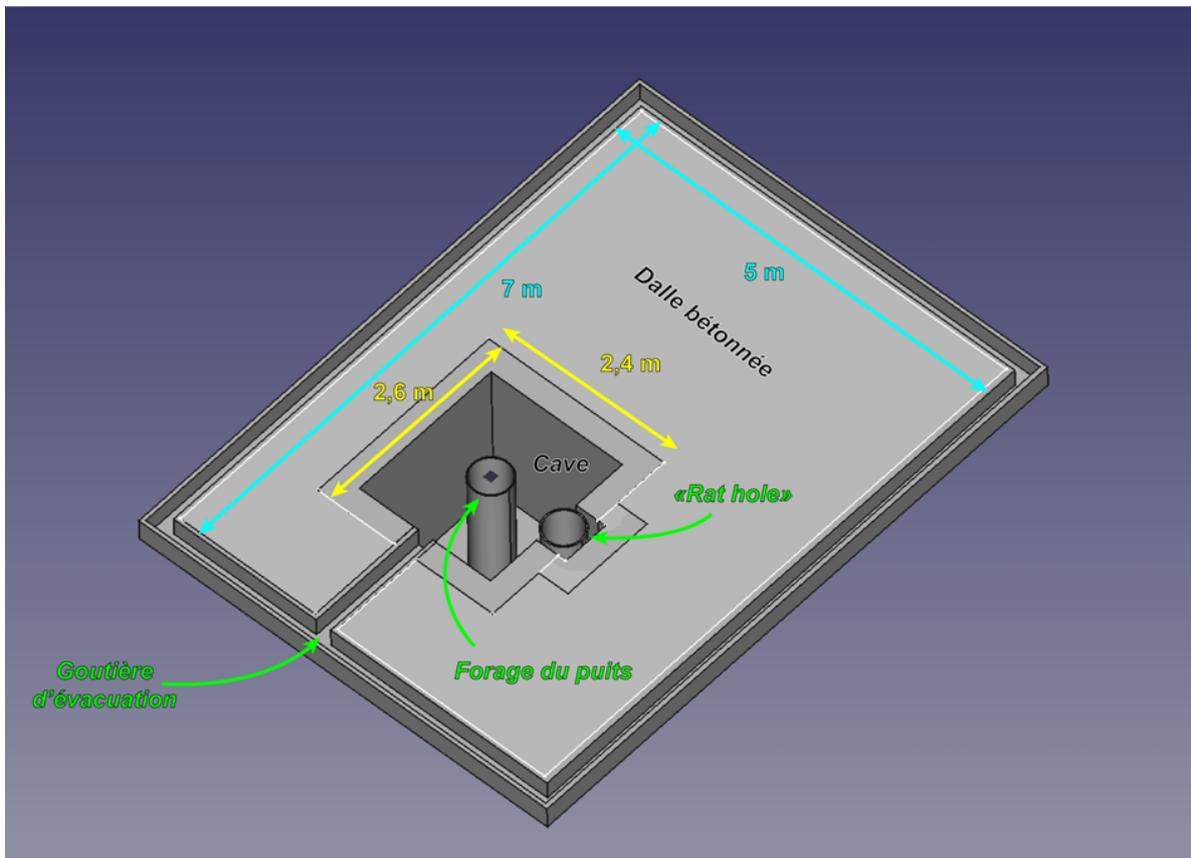
Schéma de la dalle en béton armée envisagée pour la plateforme de forage - Les mesures sont données à titre indicatif et pourront être modifiées si besoin
